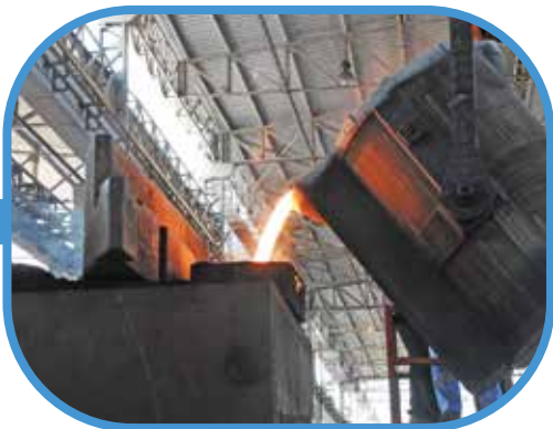
Magnesium Treatment & Pouring
